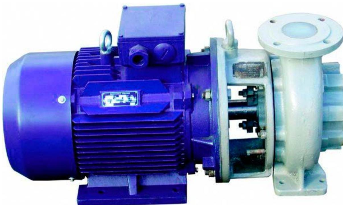
Электронасосы типа КМ предназначены для работы в стационарных условиях для перекачивания чистой воды (кроме морской) с рН 6...9, температурой от 273 до 385К (от 0 до 85оС) и других жидкостей, сходных с чистой водой по плотности, вязкости и химической активности, содержащих твердые включения в количестве не более 0,1% по объему и размером частиц не более 0,2мм.
