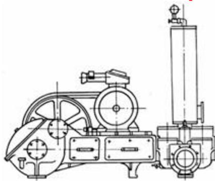
Предназначен для перекачивания нефтепродуктов с температурой до 100оС в условиях нефтебаз.
